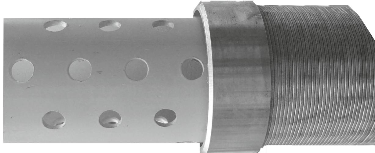
Il filtro per pozzi, con base tubolare ad infilaggio si ottiene da due componenti una base tubolare e un filtro avvolto con filo. Il tubo è perforato per permettere di aumentare la superficie filtrante. La finitura può essere nero, zincato o Inox. La giunzione può essere a saldare, manicottato o flangiato. Questo soluzione aumenta la resistenza al collasso.
